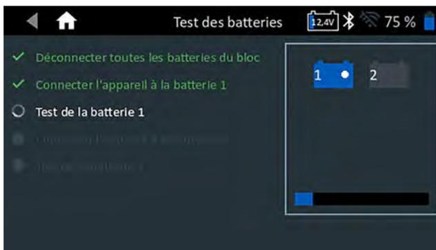
5. Une fois la dernière batterie du bloc testée, les résultats des tests individuels des batteries s'affichent.
