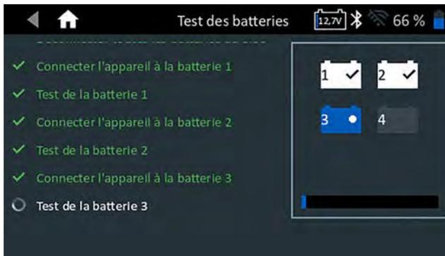
Une fois la dernière batterie du bloc testée, les résultats des tests individuels des batteries s'affichent.
